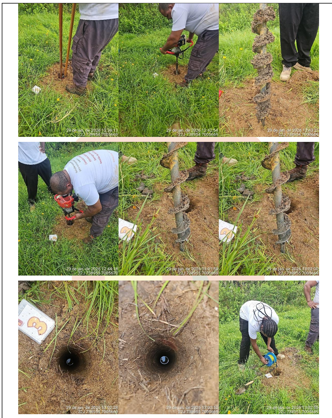
Figura 8. Sondagem ST-03.
